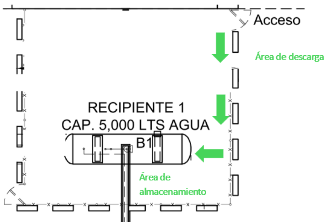
Figura 27. Nodo 1 “Proceso de trasiego de gas L.P. de autotanque al recipiente de almacenamiento”
